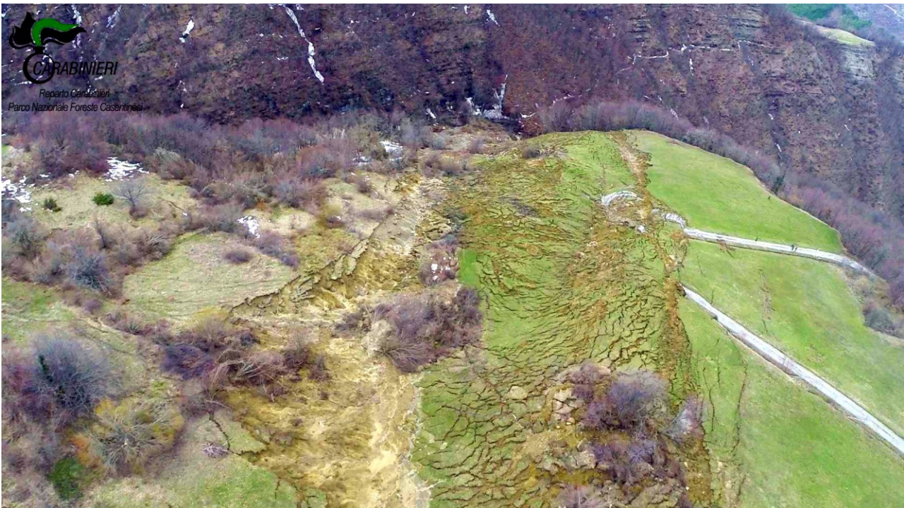
Fig. 24: nella pagina precedente: vista del coronamento della frana di Pian di Stura (Portico e San Benedetto, FC). In alto vista del piede della frana da drone. A destra si nota la strada forestale dislocata di circa 15 metri a valle. Immagini concesse dai Carabinieri Forestali del Parco Nazionale Foreste Casentinesi.
