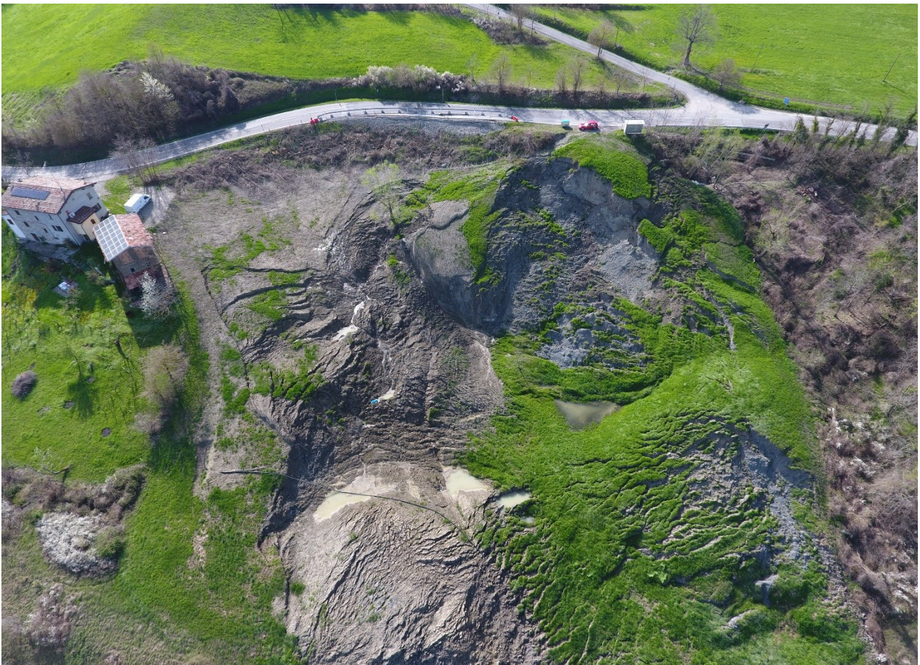
Fig. 33: frana della Pioppa di Villa Minozzo, zona del coronamento (Foto da drone di G. Bertolini, Servizio area Po). Si nota la vicinanza della frana ai due edifici sulla sinistra dell'immagine.
